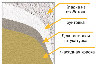
Система наружной отделки стен из газобетона Сибит (фасадная штукатурка)
