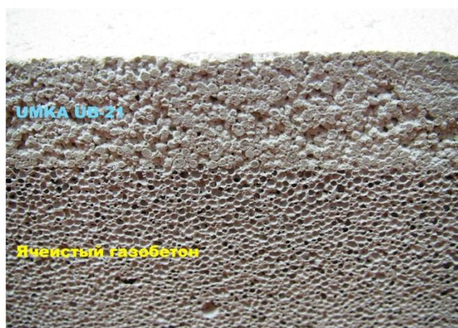
Рис. 1. Макросъемка среза штукатурного слоя УМКА UB-21, нанесенного на газобетон.
