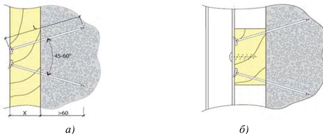
Рис. 12. Гвоздевое крепление обрешетки: а — деревянный брус, набитый на кладку непосредственно; б — крепление профиля через опорный брусок
