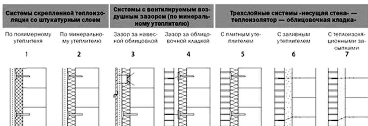
Рис. 20. Системы теплоизоляции
