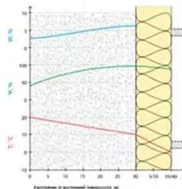
Рис. 24. Распределение влаги, температуры и влажности воздуха в порах материала по толщине стены в отопительный период.
