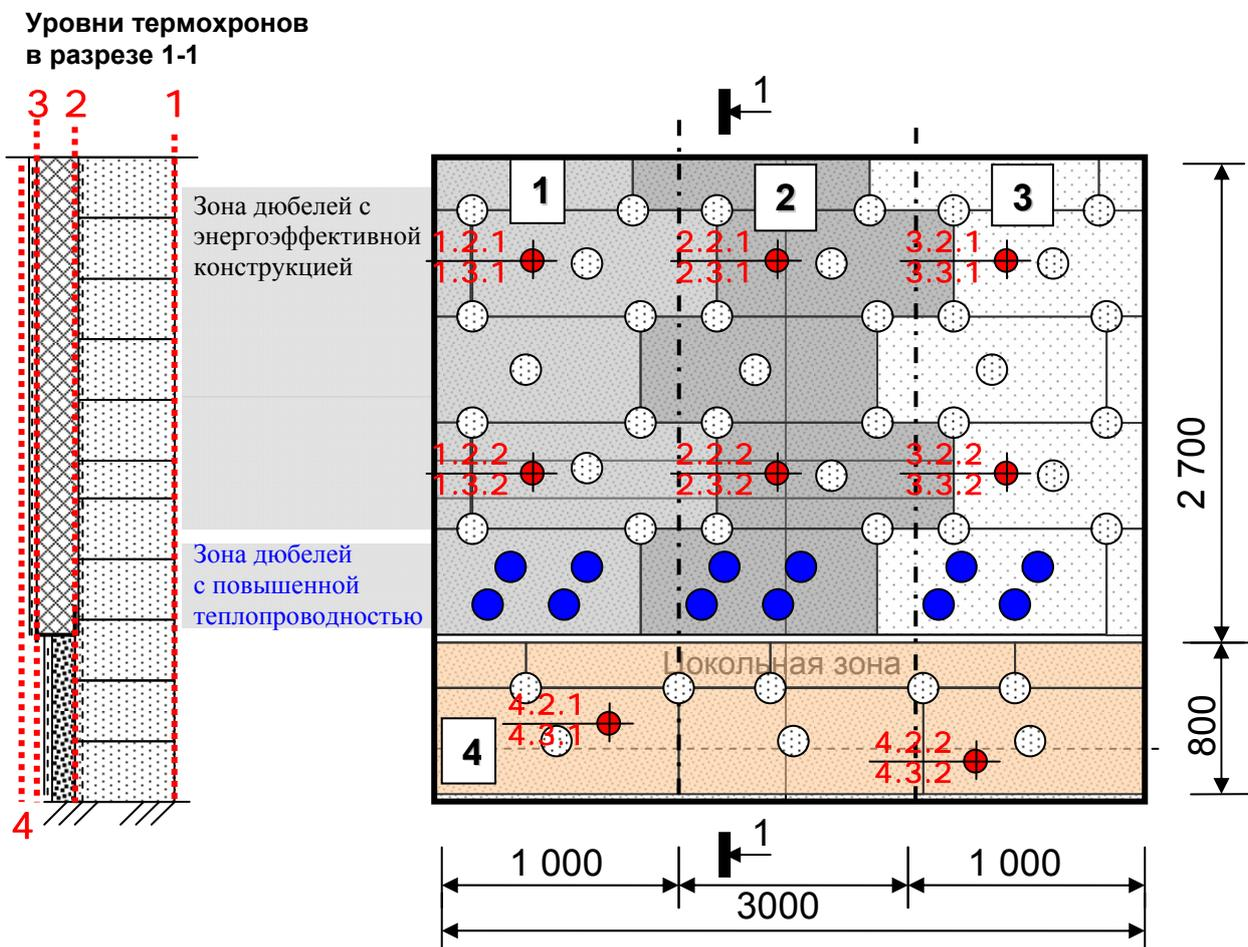
Рис. 4. Схема фрагмента стены из газобетонных блоков с наружной теплоизоляцией и защитно-декоративной отделкой Ceresit
