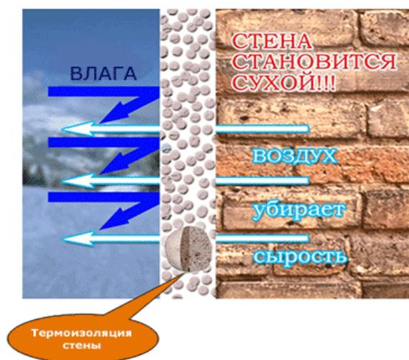
Применение теплоизоляционных смесей торговой марки УМКА® позволяет снизить затраты на отопление помещений за счёт снижения теплового потока вследствие увеличения термического сопротивления одной из ограждающих конструкций — покрытия.
