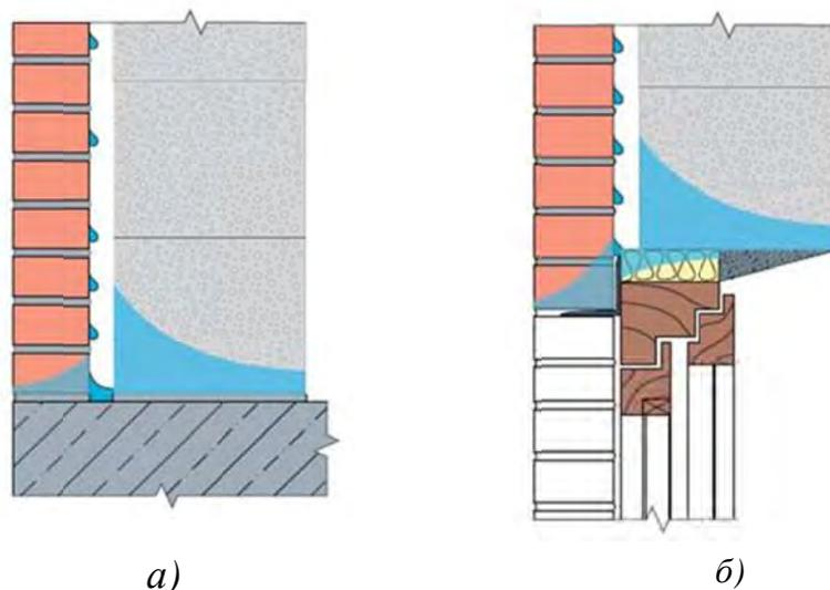
Рис. 10. Конденсат на внутренней поверхности облицовок.
