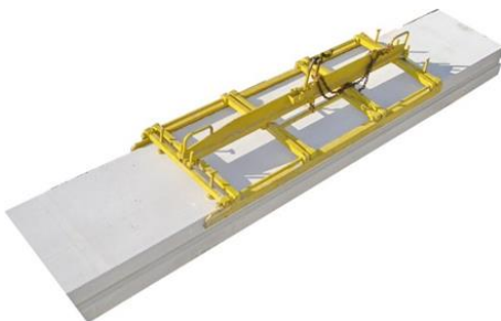
Рис.8 Захват для плит
