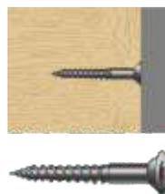
Саморезы с крупной резьбой, технический термин - coarse thread. Изготовлены из оксидированной стали С 1022, в большинстве случаев покрываются фосфатом. Имеют крестообразный шлиц и однозаходную резьбу. Предназначены для черновых работ по деревянным, гипсокартонным, пластиковым поверхностям.
