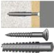
Применяется для крепления в мягких материалах (газобетон, пенобетон), а также для монтажа в плотных материалах для крепления пожароопасных конструкций. Монтаж производится путем предварительного сверления отверстия в два раза меньшего диаметра выбранного дюбеля, совместно с дюбелем используются универсальные саморезы.
