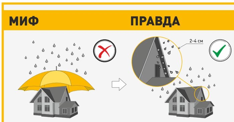
Дом из автоклавного газобетона может эксплуатироваться без отделки после обустройства кровли, водостоков, подоконников и мест возле отмостки. Даже если на поверхность кладки попадает вода, то проникновение влаги вглубь составляет всего на 2-4 см. При нормальных погодных условиях происходит быстрое высыхание, поэтому уверенно можно сказать, что ни туманы, ни ливневые, затяжные или ледяные дожди не смогут значительно увлажнить и навредить газобетонной кладке.
