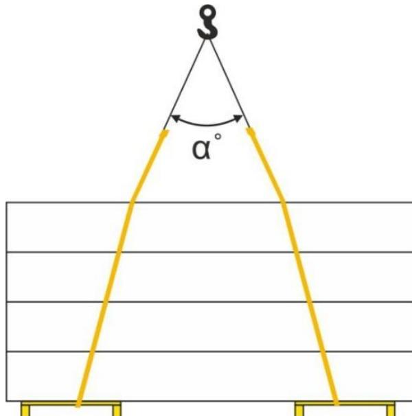
Рис.8 Разгрузка армированных изделий с использованием мягких строп
