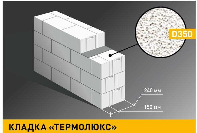
Стена  $b=400$  мм. Кладка в два блока
