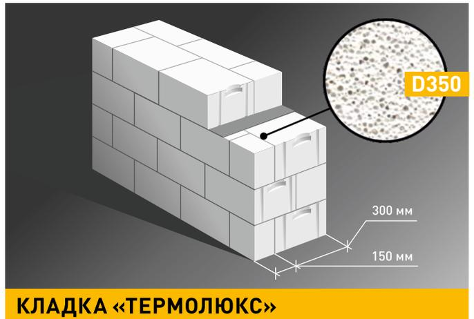
Стена  $b=450$  мм. Кладка в два блока
