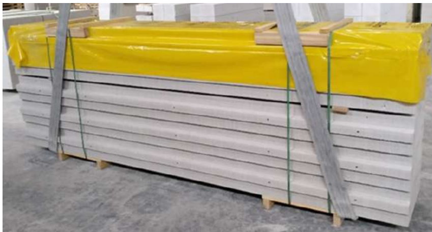
Рис.1 Схема упаковки пачек с панелями перекрытий
