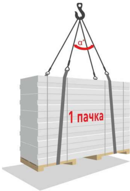
Рис.8 Разгрузка армированных изделий с использованием мягких строп
