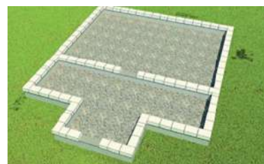
6. Выкладывается первый ряд блоков
