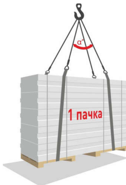
Рис.8 Разгрузка армированных изделий с использованием мягких строп
