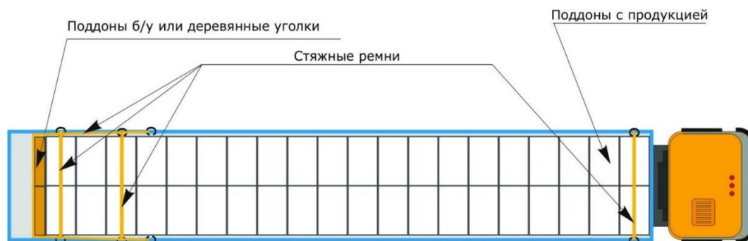
Рис.2 Схема обвязки и крепления поддонов с продукцией (блоки) на автотранспортном средстве.
