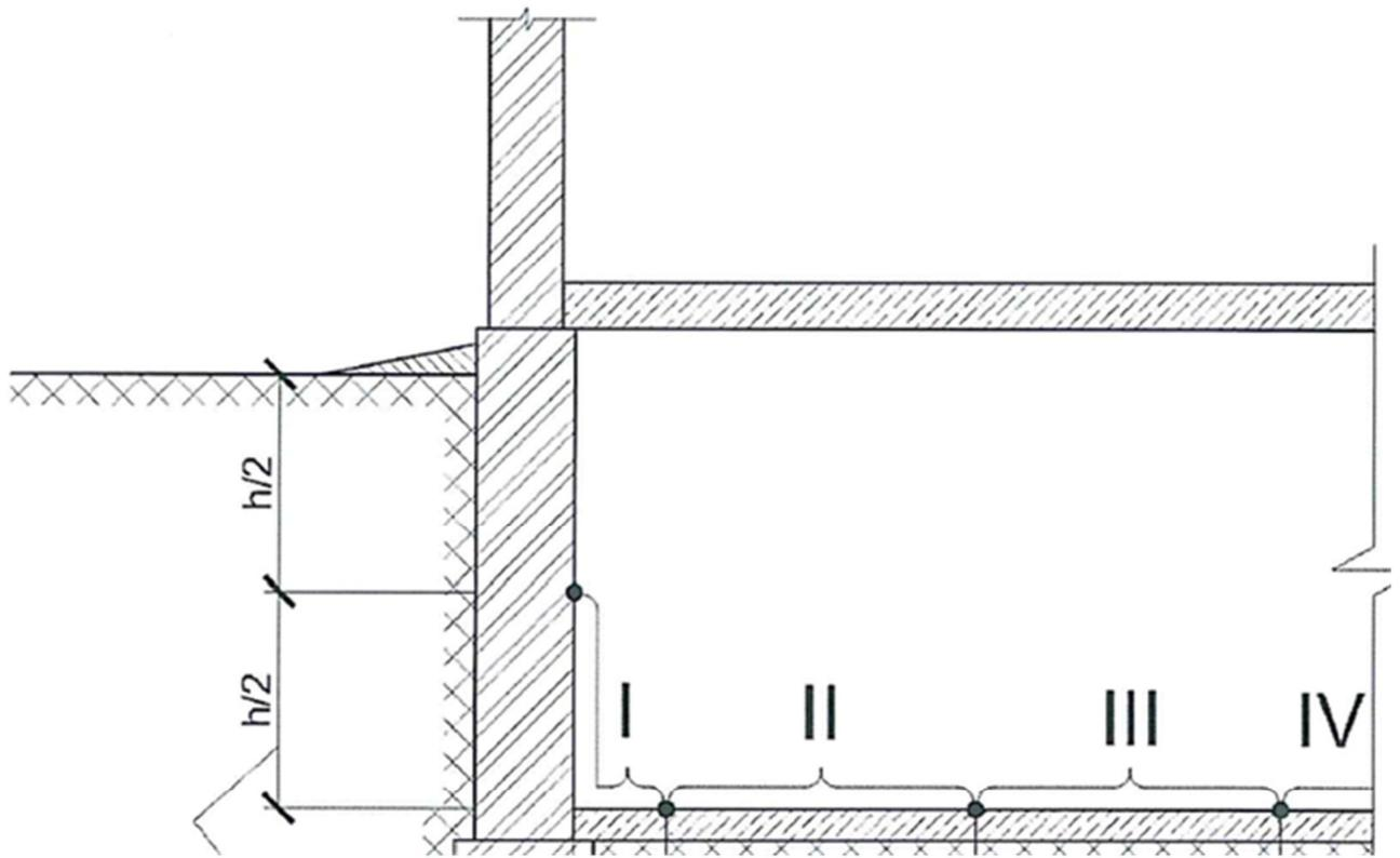
Рисунок Е.1 — Деление на зоны пола по грунту
